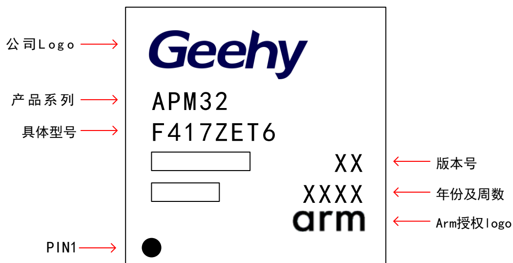
图 21 LQFP144 -144 引脚，20 x20mm 示意图
