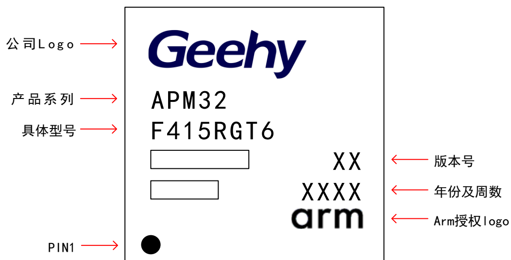
图 27 LQFP64 - 64 引脚，10 x 10mm 示意图
