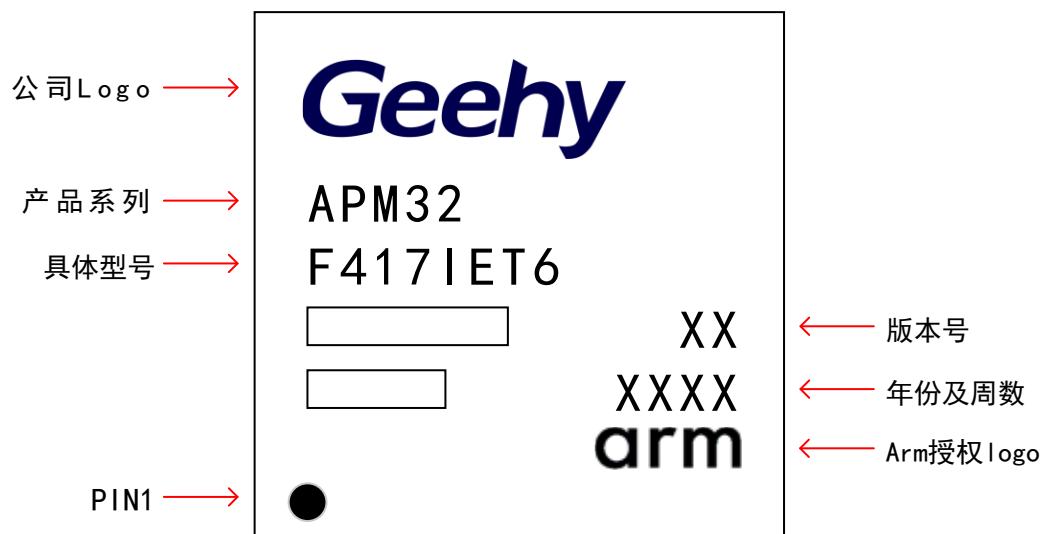
图 18 LQFP176 -176 引脚，24 x24 mm 示意图
